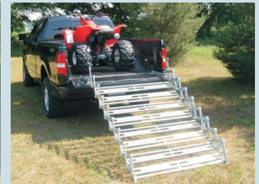
Die Rampe ruht auf der Ladefläche. Bei Bedarf ausziehen und entfalten.
