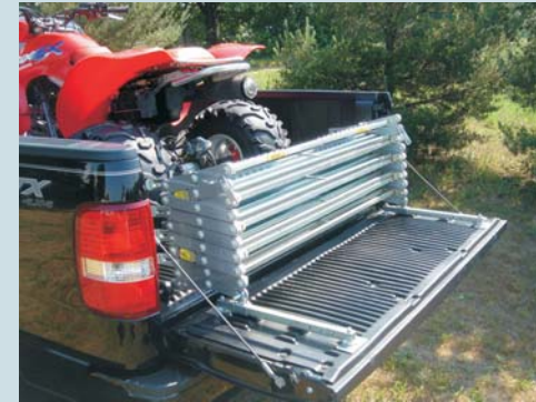
Die Rampe ruht auf der Ladefläche. Bei Bedarf ausziehen und entfalten.
